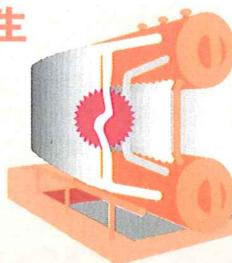
ボイラー用制御盤に配水管からの汚水が浸入したため配線に絶縁破壊発生
